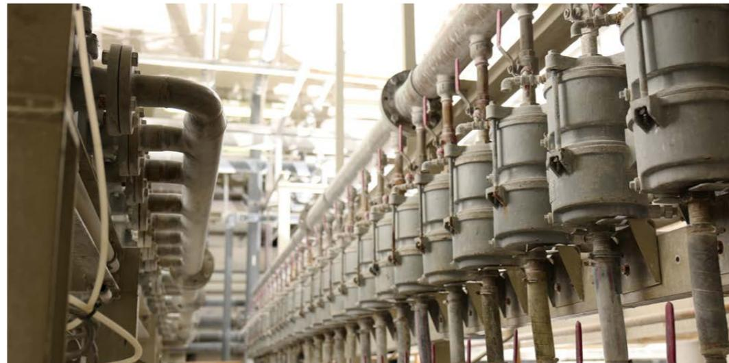
Abtrennung der Sandfraktionen und Klassierung in verschiedene Korngrößen durch Hydrozyklone
