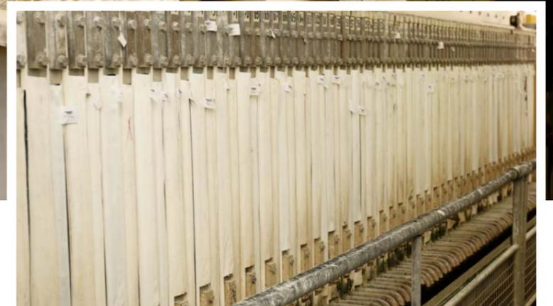
Entwässerung durch Filterpressen
