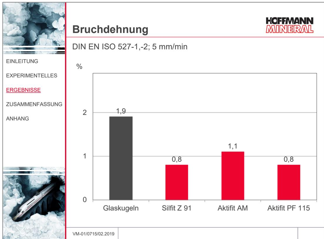
Die Bruchdehnung liegt mit Glaskugeln bei ca. 2 %, mit den anderen Füllstoffen bei ca. 1 %.
