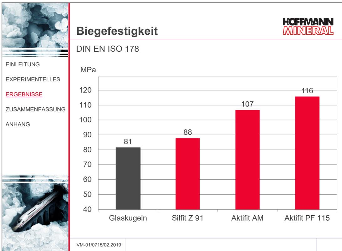
Die Festigkeit im Biegeversuch liegt insgesamt auf einem höheren Niveau als im Zugversuch. Bereits das nicht oberflächenhandelte Silfit Z 91 bewirkt eine höhere Festigkeit als die Glaskugeln. Durch die Oberflächenbehandlung mit der amino-funktionellen Gruppe lässt sich die Festigkeit weiter steigern und übertrifft so das Ergebnis der Glaskugeln um bis zu 43 %.
