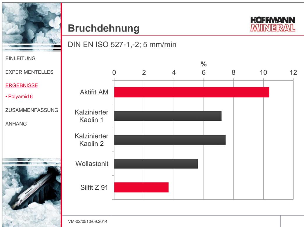
Im Vergleich zu den Wettbewerbern brachen die Proben mit Aktifit AM erst bei deutlich höherer Dehnbeanspruchung. Dies entspricht einer Verbesserung von mindestens 40 % gegenüber den Kaolinen und ca. 85 % gegenüber Wollastonit. Nutzbar wird dieser Effekt bei allen Anwendungen, wo Bauteile beim Einbau einer bestimmten Verformung widerstehen müssen, wie zum Beispiel Schnapphakenverbindungen.
