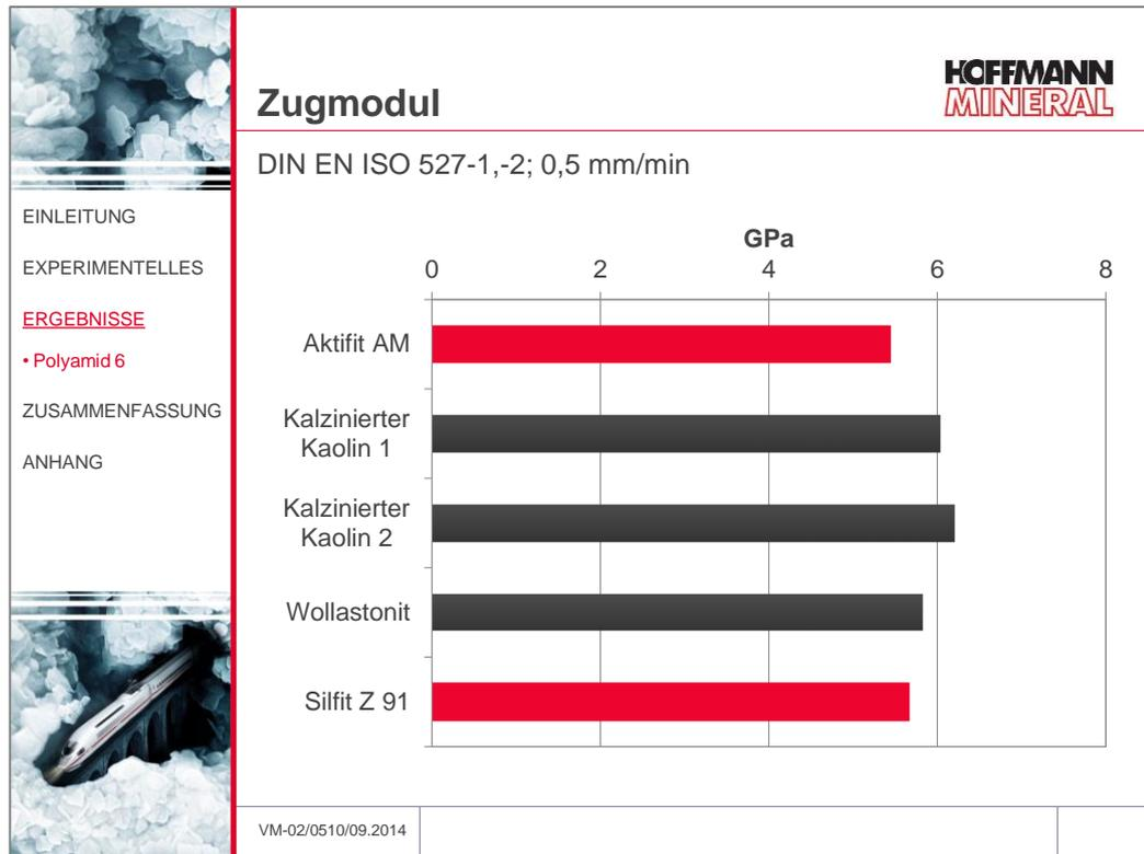
Mit den beiden Kaolinen, vor allem Kaolin 2, lag die Steifigkeit etwas höher. Aktifit AM erreichte annähernd vergleichbare Werte wie Wollastonit.
