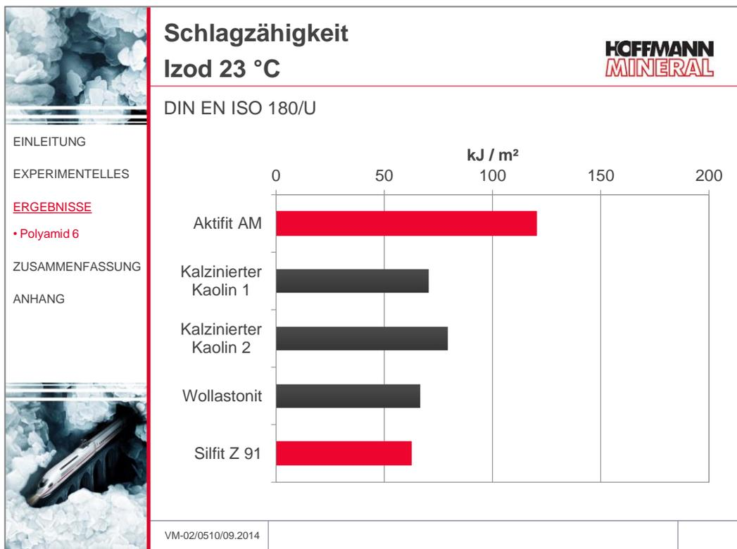
Bei dieser Prüfanordnung wurden insgesamt etwas geringere Schlagzähigkeiten gefunden. Im Prinzip ergab sich die gleiche Reihung der Füllstoffe, Aktifit AM sogar noch deutlicher abgesetzt von den Wettbewerbern.
