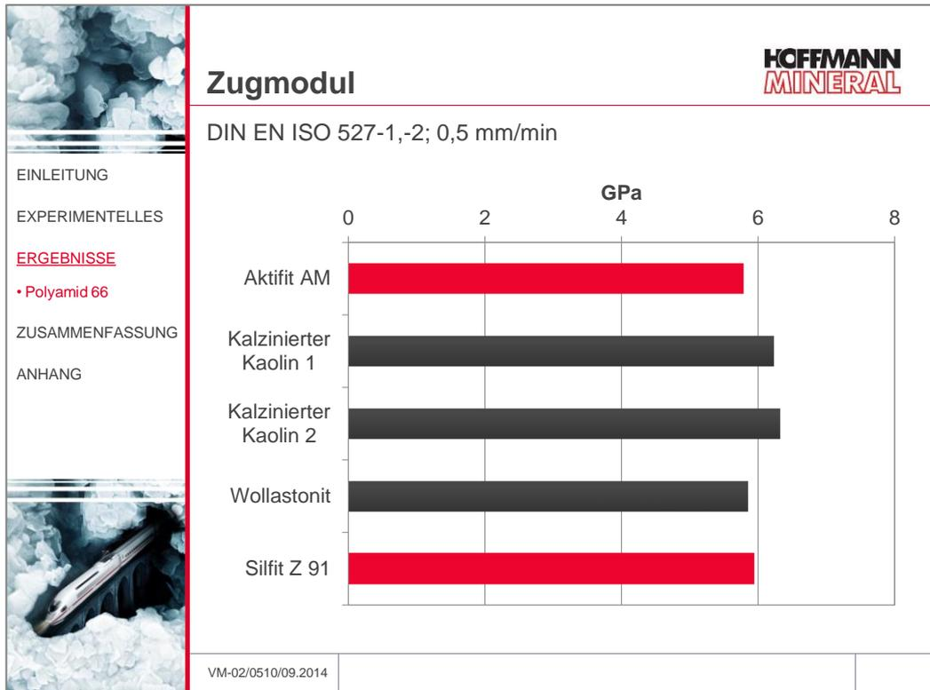
Die Kaoline ergaben eine etwas höhere Steifigkeit. Aktifit AM lag auf vergleichbarem Niveau wie Wollastonit.
