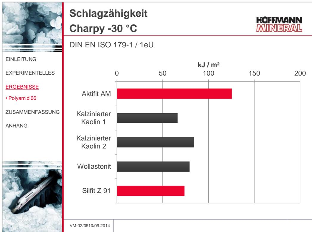
Bei Tieftemperatur ging das Ergebnisniveau zurück – die Reihung der Füllstoffe und der signifikante Vorsprung von Aktifit AM blieben jedoch erhalten. Selbst bei -30 °C war das Schlagzähigkeitsniveau mit Aktifit AM höher als mit den Wettbewerbsfüllstoffen bei Raumtemperatur.
