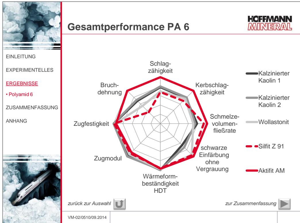
Aktifit AM konnte in Polyamid 6 vor allem hinsichtlich Schlagzähigkeit und Bruchdehnung überzeugen. Gegenüber den geprüften kalzinieren Kaolinen wurde die Fließfähigkeit deutlich verbessert. Schwarze Compounds ließen sich ohne Aufhellung bzw. Vergrauung mit Aktifit AM herstellen. Die Festigkeit blieb auf dem Niveau von Wollastonit. Leichte Einbußen ergaben sich lediglich bei der Steifigkeit (Zugmodul).
