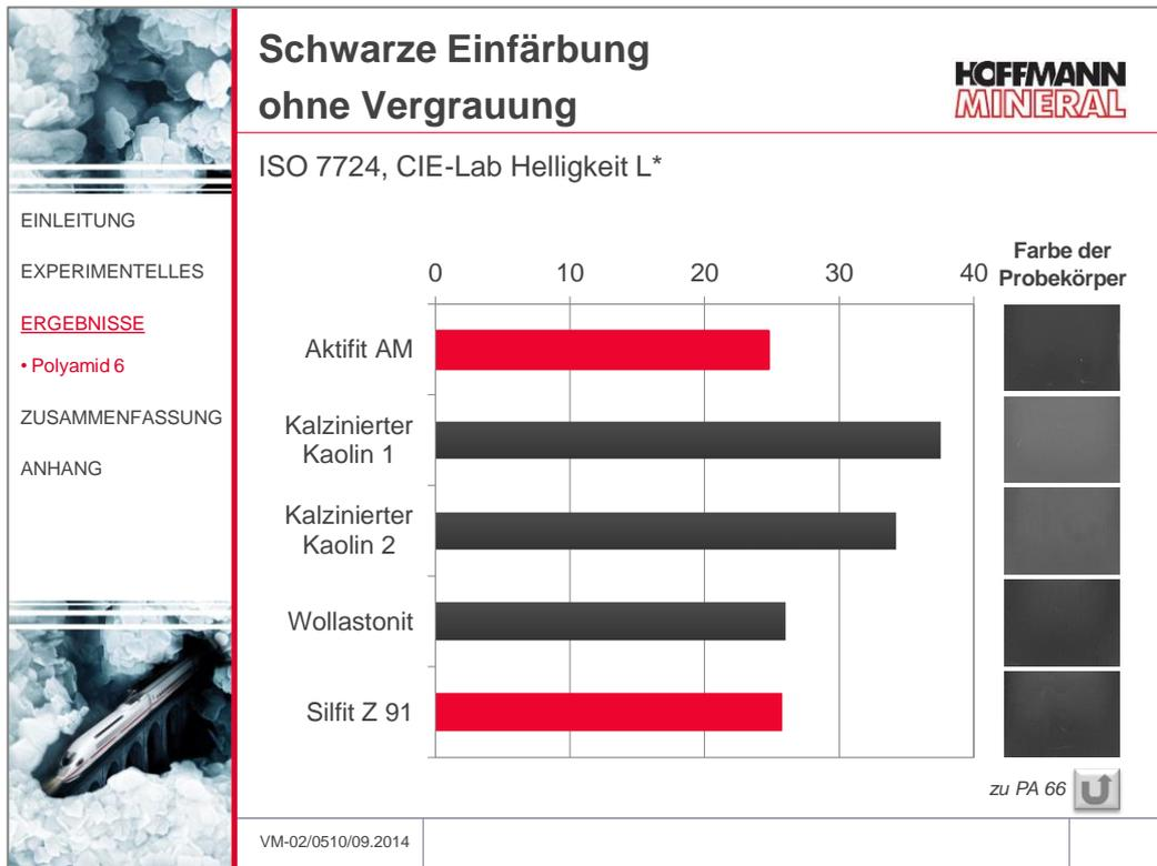
Die beiden Kaoline führten in den schwarzen Compounds zu einer deutlichen Aufhellung bzw. Graufärbung. Mit Aktifit AM bzw. Silfit Z 91 und Wollastonit war das nicht der Fall. Da eine Vielzahl der Polyamid Anwendungen schwarz ist, stellt die Vermeidung von Vergrauung bzw. ein geringerer Bedarf an Pigmentbatch durch Aktifit AM einen Zusatznutzen dar.
