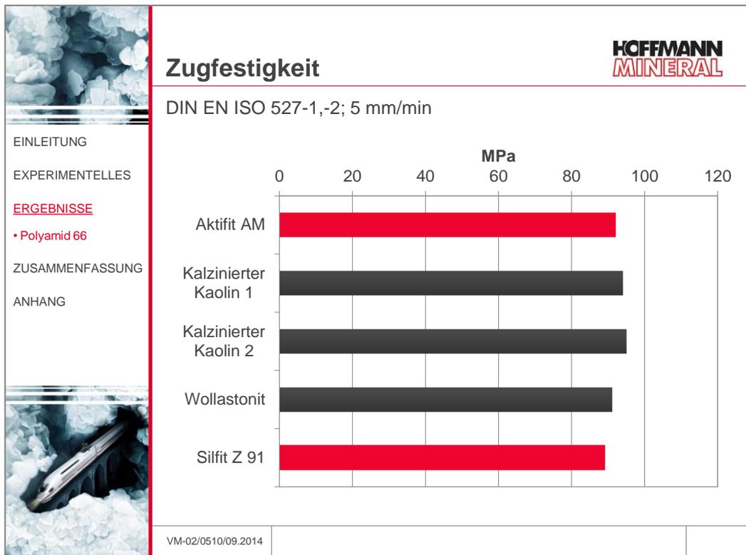
Im Zugversuch traten keine auffälligen Unterschiede in der Festigkeit auf. Die beiden Kaoline tendierten wieder zu geringfügig höheren Ergebnissen.
