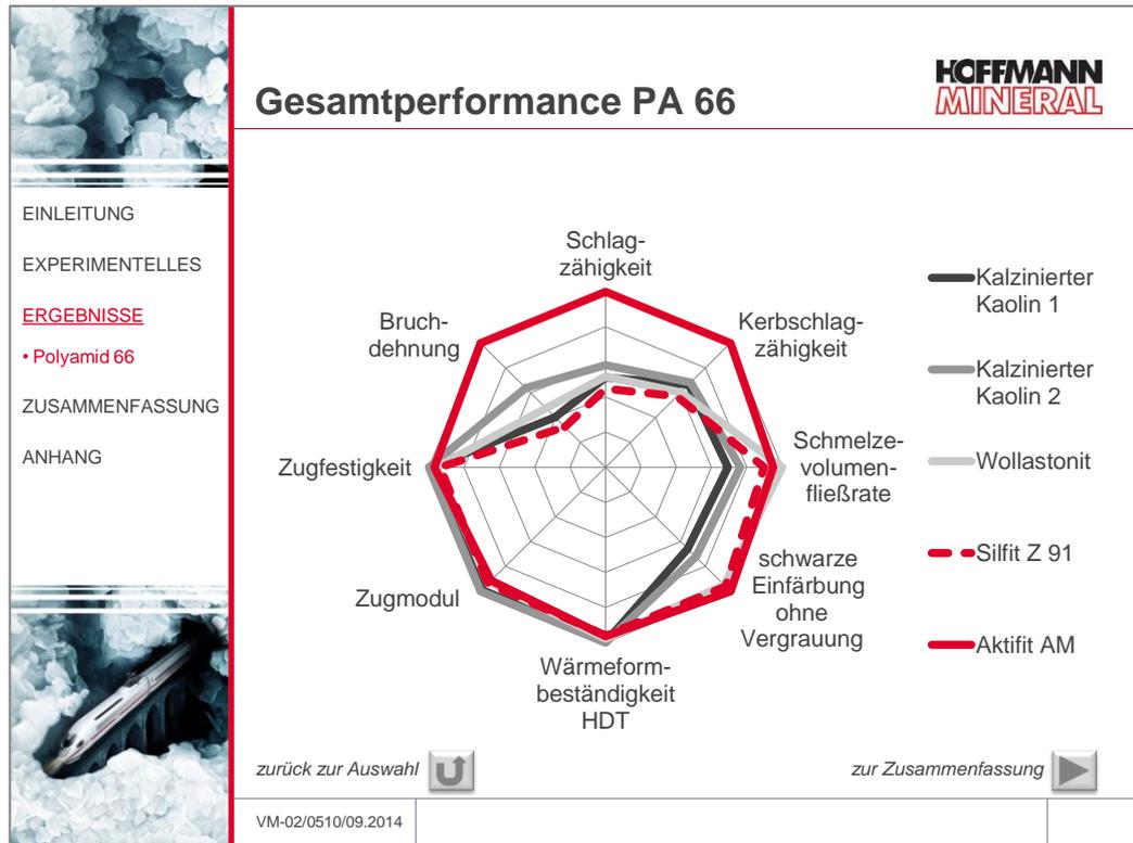
In den beiden geprüften Polyamid 66 Typen (Ultramid® A3K und Schulamid® 66 MV 2) ergaben sich durch Aktifit AM bemerkenswerte Vorteile hinsichtlich Schlagzähigkeit und Bruchdehnung. Im Vergleich zu den beiden kalzinierten Kaolinen wurden bessere Fließeigenschaften festgestellt, zudem war in schwarzen Compounds eine tiefere Schwarzfärbung ohne Vergrauung mit Aktifit AM möglich.
