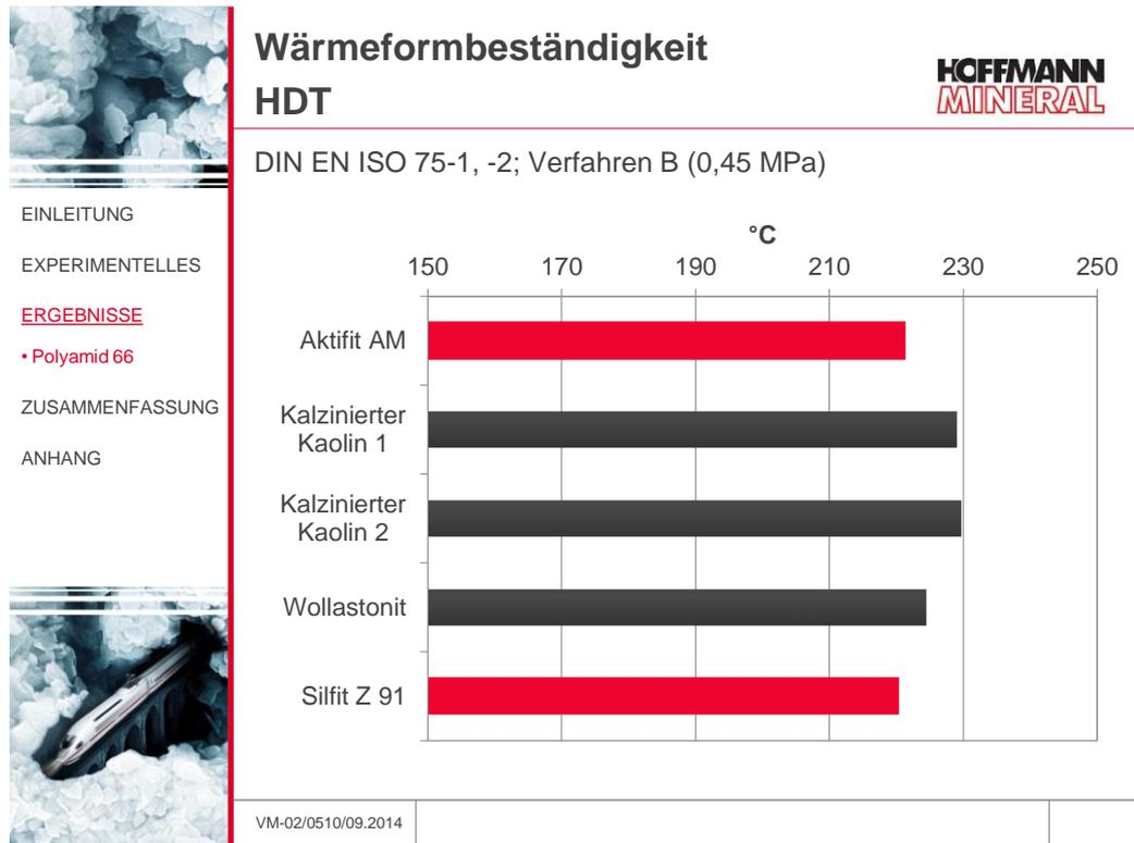
Beide Kaoline bewirkten hier eine etwas höhere HDT als Wollastonit und Aktifit AM, was hauptsächlich auf den leicht unterschiedlichen E-Modul zurückzuführen sein sollte.
