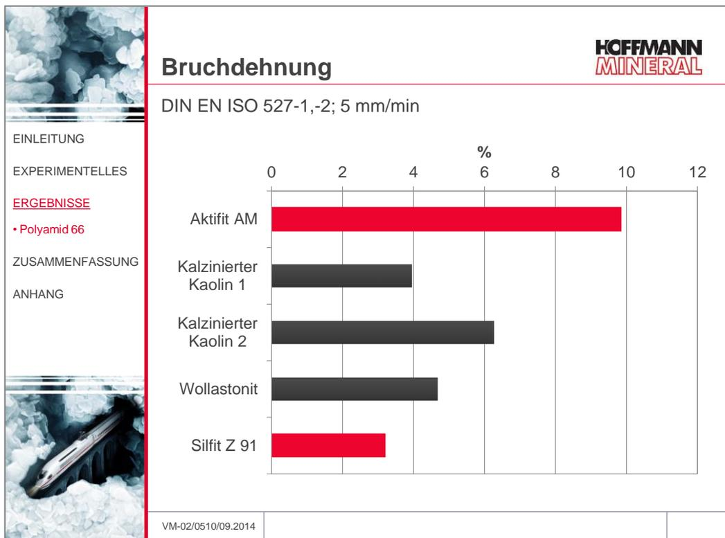
Der Bruch der Proben mit Aktifit AM erfolgte im Vergleich zu den Wettbewerbern erst bei doppelter Dehnbeanspruchung. Dies entspricht einer Verbesserung von mindestens 50 % gegenüber den Kaolinen und mehr als 100 % gegenüber Wollastonit. Nutzbar wird dieser Effekt bei allen Anwendungen, wo Bauteile beim Einbau einer bestimmten Verformung widerstehen müssen, wie zum Beispiel Schnapphakenverbindungen.
