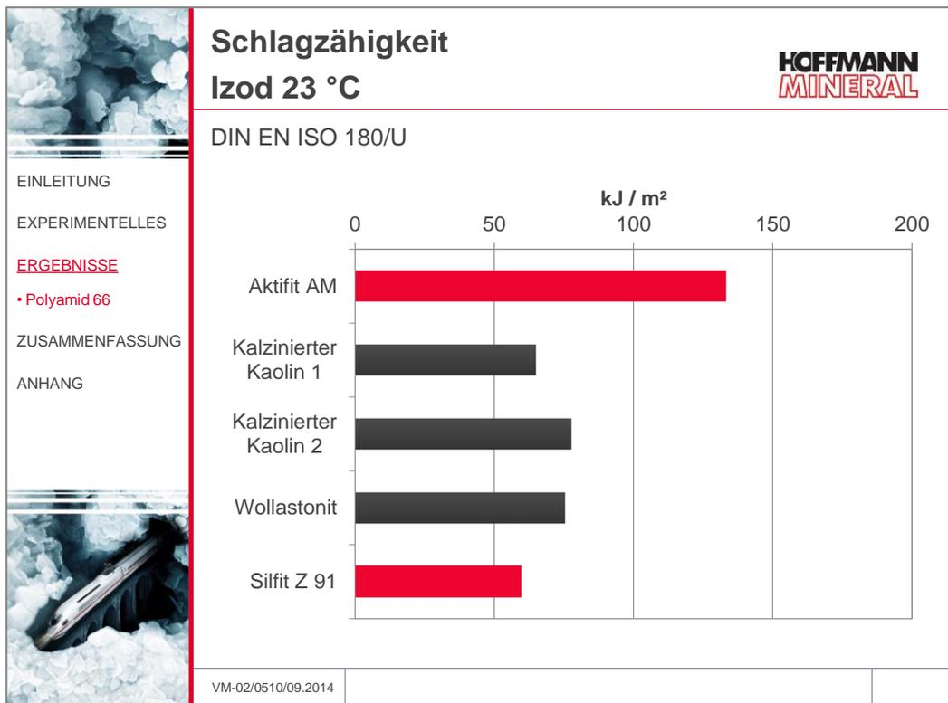
Auch bei Polyamid 66 resultierte die geänderte Prüfanordnung nach Izod in insgesamt etwas niedrigeren Schlagzähigkeiten. Die Reihung der Füllstoffe blieb jedoch wieder gleich.
