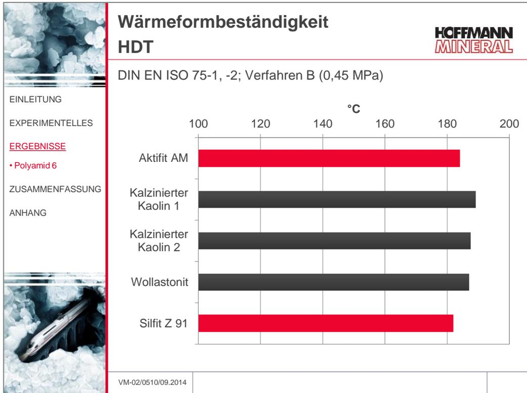
Mit den Wettbewerbsfüllstoffen war die Wärmeformbeständigkeit geringfügig höher als mit Aktifit AM, was hauptsächlich auf den leicht unterschiedlichen E-Modul zurückzuführen sein sollte.
