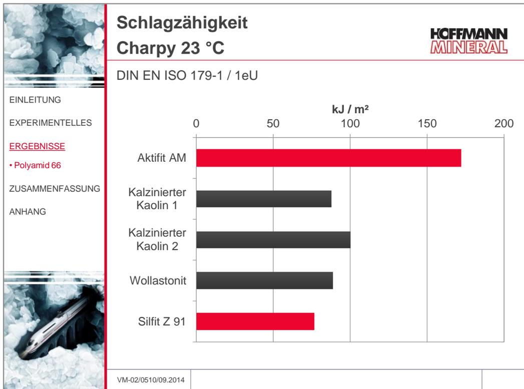
Aktifit AM zeigte hier mit einer Steigerung von bis zu 90% eine hervorragend hohe Charpy-Schlagzähigkeit und damit markante Vorteile gegenüber den Wettbewerbern.
