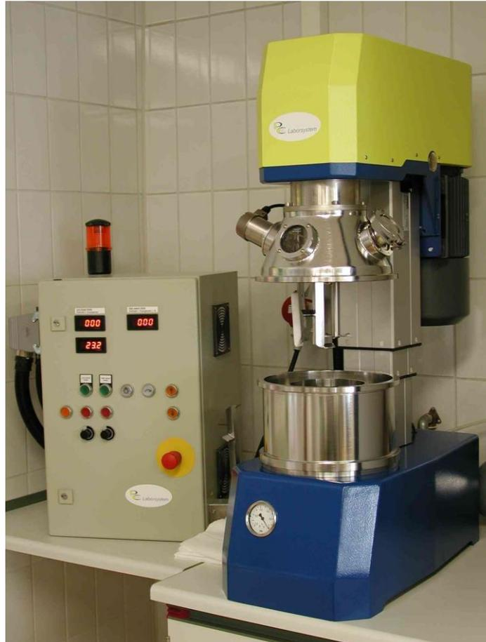
Für die Herstellung wurde ein Planetenmischer mit einer Kombination von Dissolverscheibe, Balkenrührer und Abstreifer verwendet.
