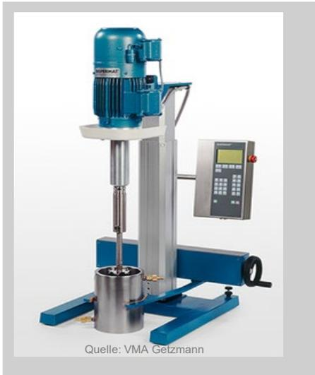
Mischen / Dispergieren am Dissolver gemäß Rohstoffreihenfolge in der Rezeptur
