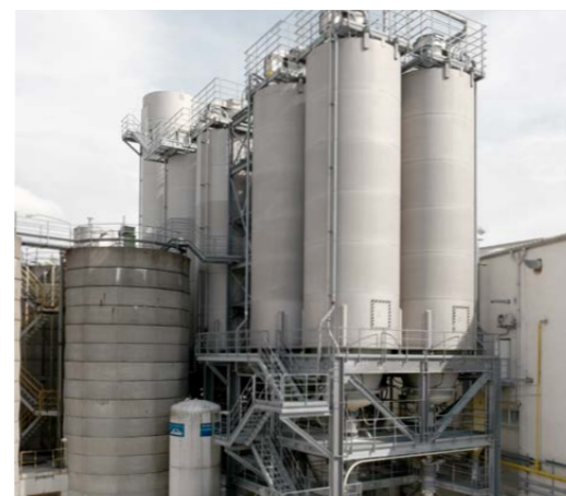
Verladesilos für die Auslieferung loser Ware durch Silofahrzeuge
