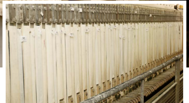
Entwässerung durch Filterpressen
