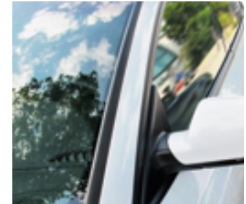
Wasserableiste an der Windschutzscheibe, SEBS-Compound auf PP-Kern im Spritzgussverfahren
